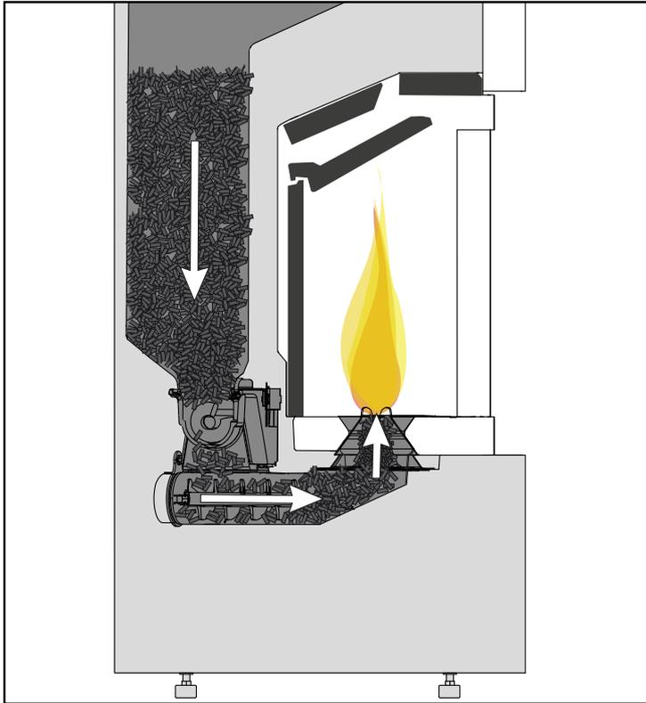
Les granulés sont stockés dans le réservoir qui se situe à l'arrière de la chambre de combustion.
