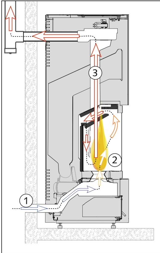
1. L'air nécessaire à la combustion est puisé à l'extérieur de l'enveloppe du bâtiment (sous le foyer ou à l'arrière de l'appareil) ou à l'intérieur du bâtiment.
