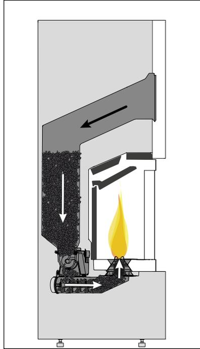
Le Stûv P20-S est muni d'un réservoir à pellet, d'un système d'alimentation en combustible, d'un système d'alimentation en air de combustion, d'un système d'extraction de fumée ainsi que d'un ensemble électronique et de sondes permettant de moduler et de régler le fonctionnement de l'appareil.
